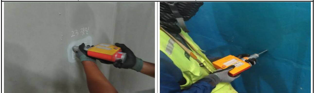
토목구조물 콘크리트 강도시험
